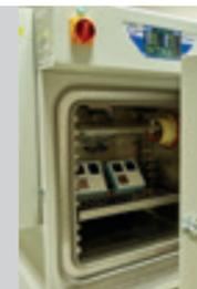
Spezifische Tests in Klimäräumen zur Kontrolle der Dichtigkeit, der Lebensdauer und der Performance der ausgewählten Materialien, bei extremen Temperaturen (Kälte und Hitze).
